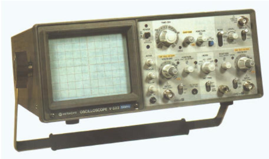
Figura 5 - Osciloscópio de 50 MHz
