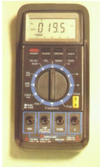
**Figura 4** - Um Multímetro e suas escalas de teste
